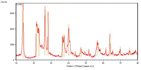
FIGURE 2 XRD spectrum of kao surface
