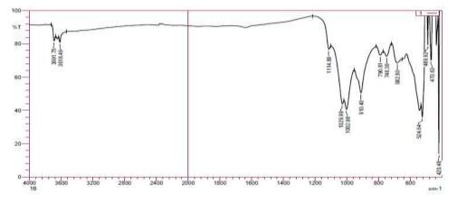
FIGURE 4 FT-IR spectrum of kao surface
